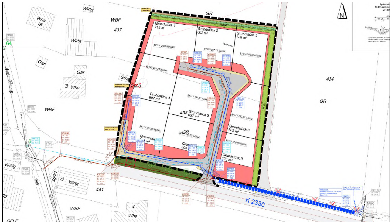
Bild 3: Lageplan Kanal (rot: Schmutzwasser, blau: Regenwasser), Pfahlbach
